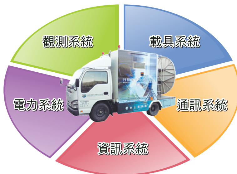
圖2-51 行動式土石流觀測站主體架構
