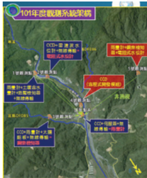
圖3-23 土石流觀測系統現場架構圖
