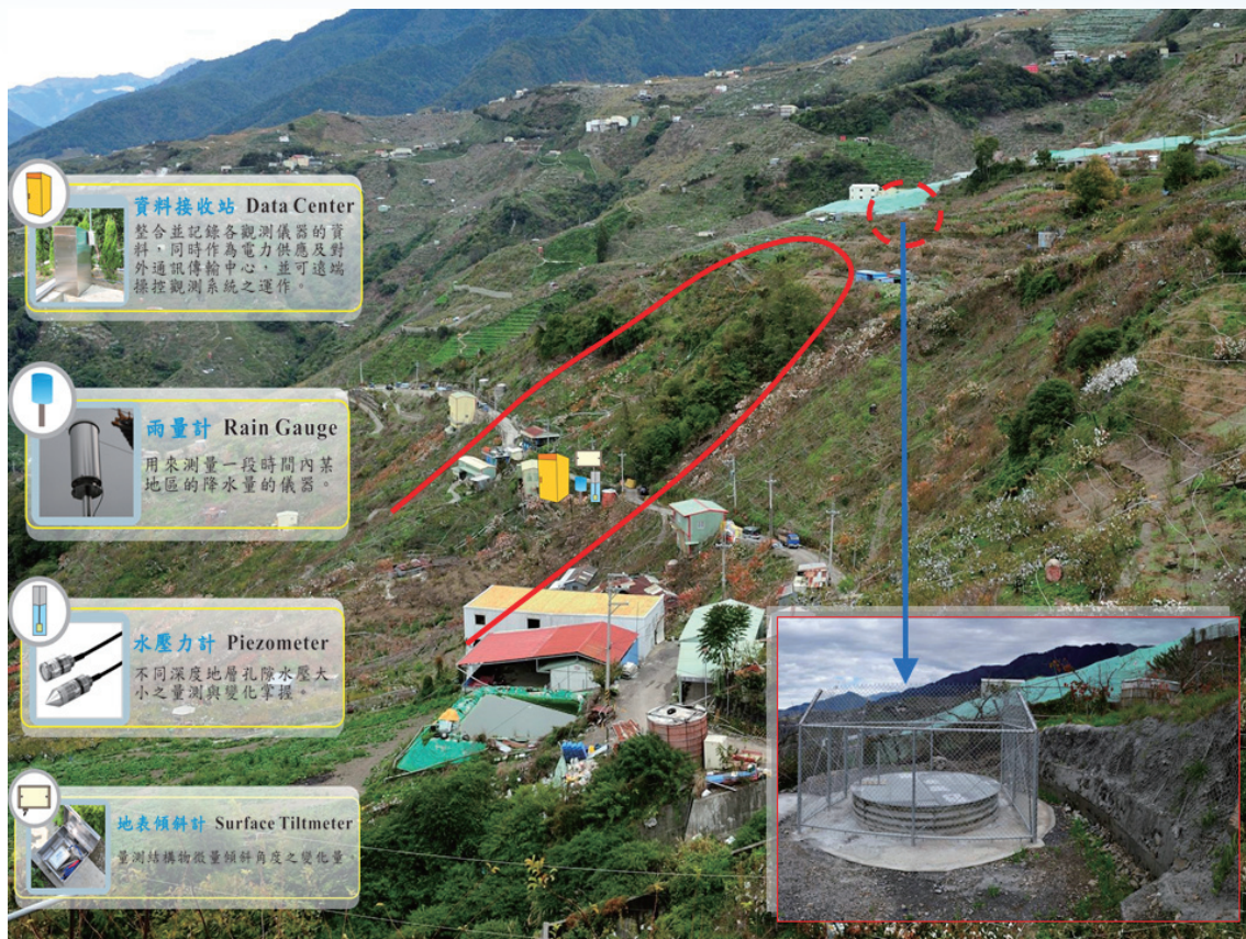
圖7-6 大梨山地區潛在大規模崩塌監測系統
