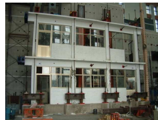
實尺寸校舍構架反覆載重試驗
