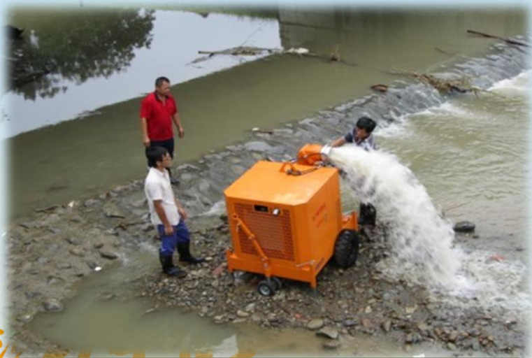
抽水機實際抽水測試
