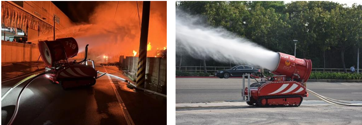
圖1、具滅火、排煙及泡沫放射功能之「消防機器人」
