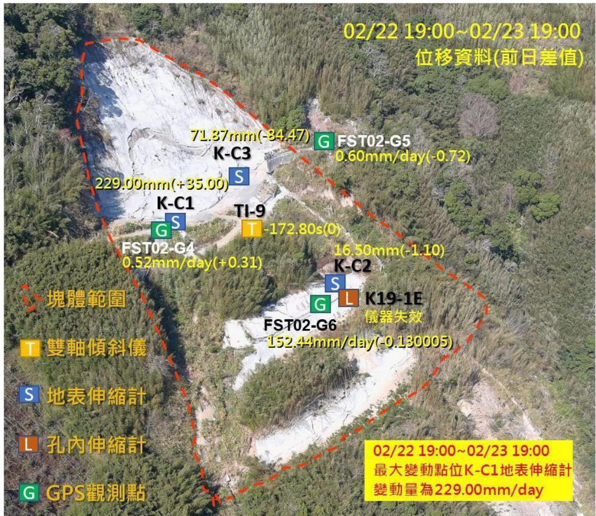
圖 2 監測儀器分布及空拍位移速率圖
