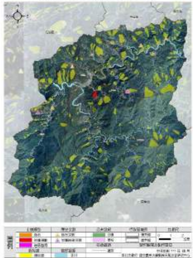
新北市坪林區山崩與順向坡分布圖
