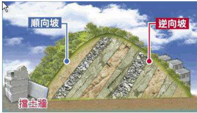
圖 2 順向坡剖面示意圖
