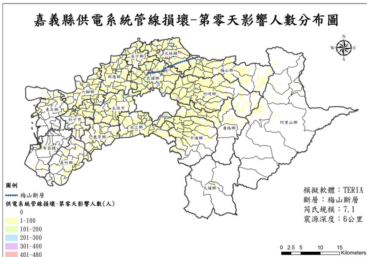
圖 3-2-9 嘉義縣供電管線損壞第零天影響人數分布圖
