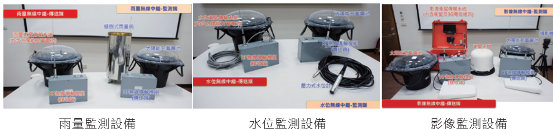
圖2-41 堰塞湖攜帶式監測設備組件
