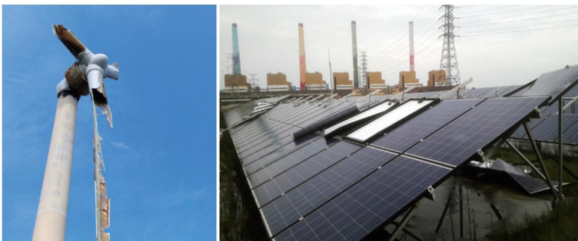
圖2-36 臺中港風場風機及龍井太陽光電站光電模組受損情形
