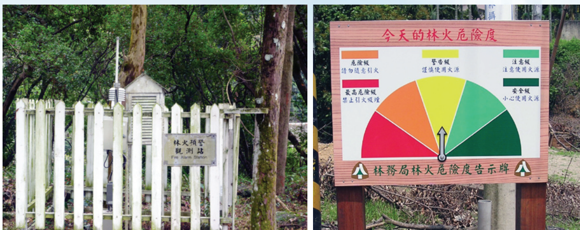
圖3-26 林火預警系統－林火危險度自動化觀測站（左）、林火危險告示牌（右）
